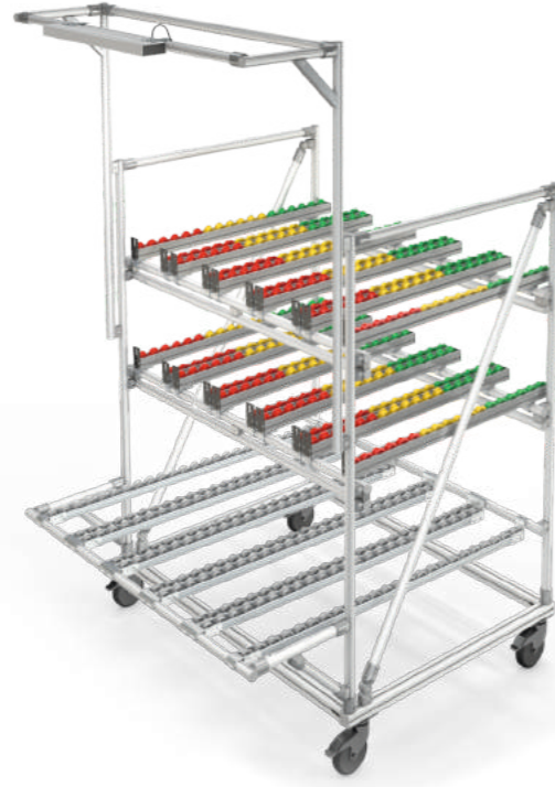
Kanban işlevselliğine sahip mobil FIFO rafı • Renkli makaralı konveyörler raf doluluk seviyelerini gösterir.
