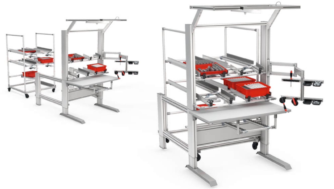
4E FIFO Shooter - Arkadan malzeme beslemeli esnek iş istasyonu • FIFO raf ile entegre çalışabilen yükseklik ayarlı çalışma masası sayesinde, klt kutular operatör önüne otomatik olarak aktarılır. • Boş kutular masanın altından rafa aktarılır ve bu şekilde malzeme döngüsü pratik şekilde sağlanır.
