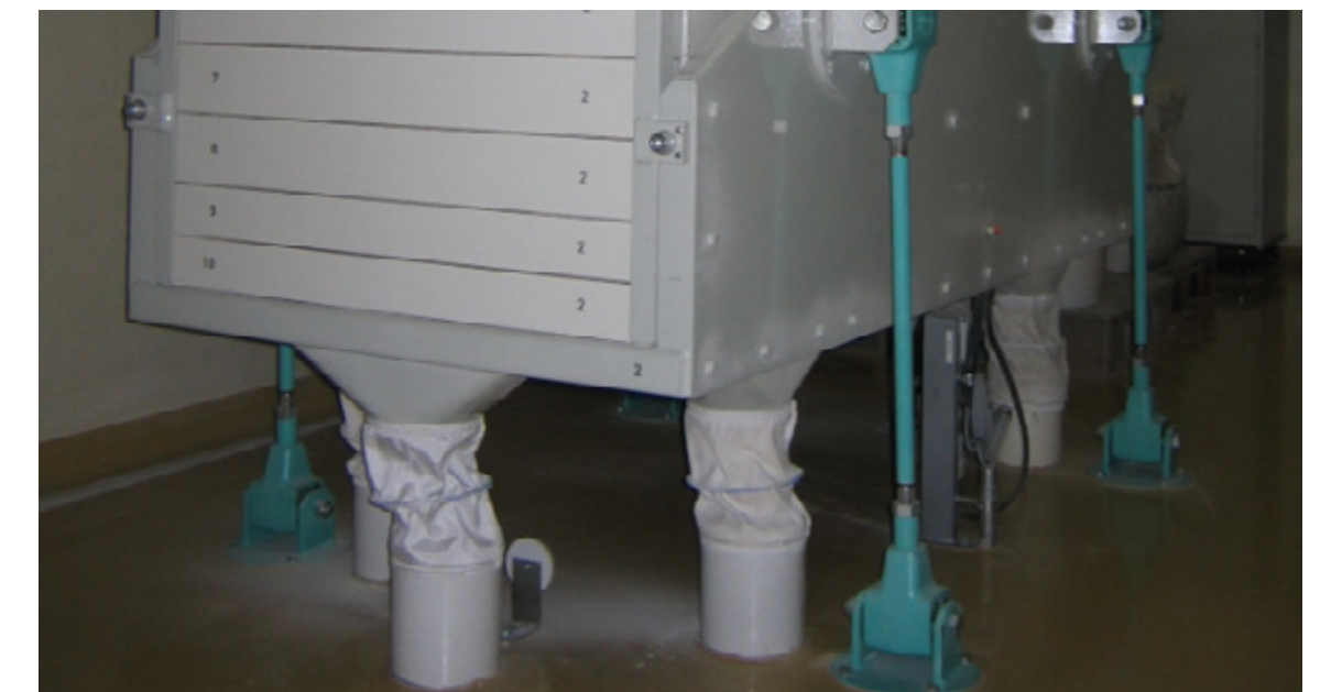
Mill Sifter designed with ROSTA AV ®
